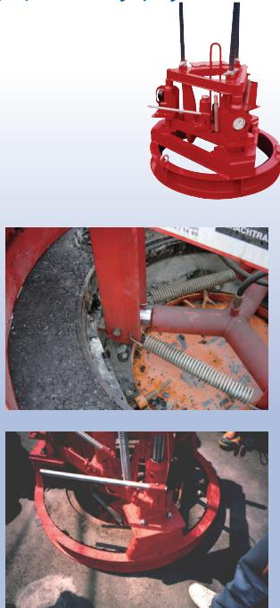
**カッターを使わず、受枠を撤去できます。**
