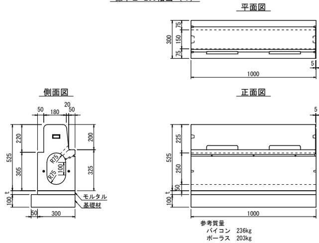
【参考図】 ライン導水ブロックF型 構造図
