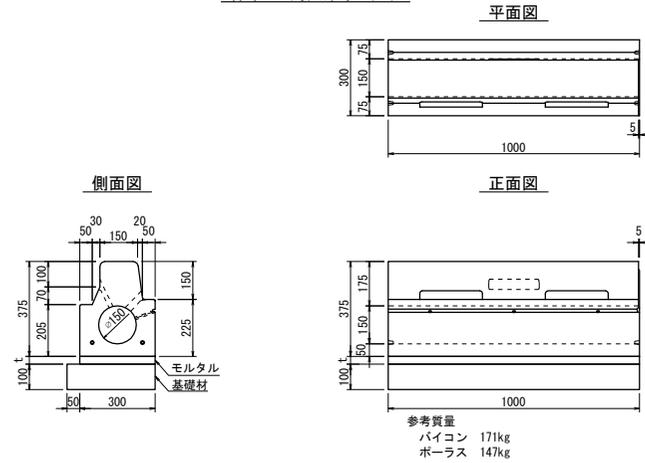
【参考図】 ライン導水ブロックF型 構造図
